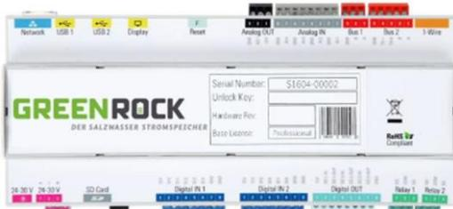
Das GREENROCK EMS bildet das Herzstück der Anwendung und stellt die Basis in allen GREENROCK Versionen dar. Das Energie-Management-System kümmert sich um die Erfassung aller relevanten Anlagendaten wie Überschuss, Bezug, PV Erzeugung und Eigenverbrauch, übernimmt als zentrales Gehirn die gesamte Steuerung aller Anwendungen und sorgt durch die integrierte Intelligenz für einen optimalen Betrieb des gesamten Systems.
